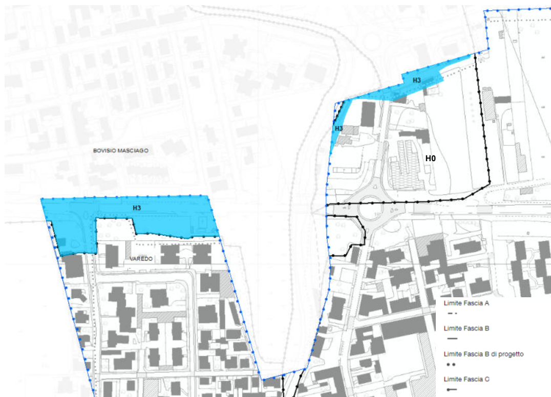
Figura 31. Proposta di zonazione della pericolosità idraulica nelle aree poste a tergo del limite di fascia B di progetto ovvero allagabili per evento con tempo di ritorno pari a 100 anni. Le aree in bianco si trovano ad una quota superiore rispetto al livello al colmo assunto
