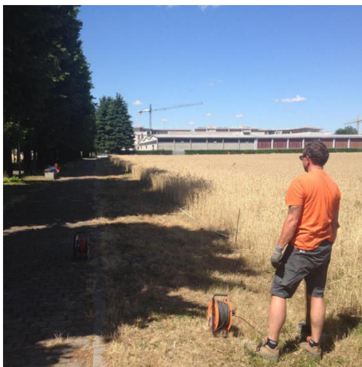
Figura 41. Esecuzione del profilo sismico MASW
