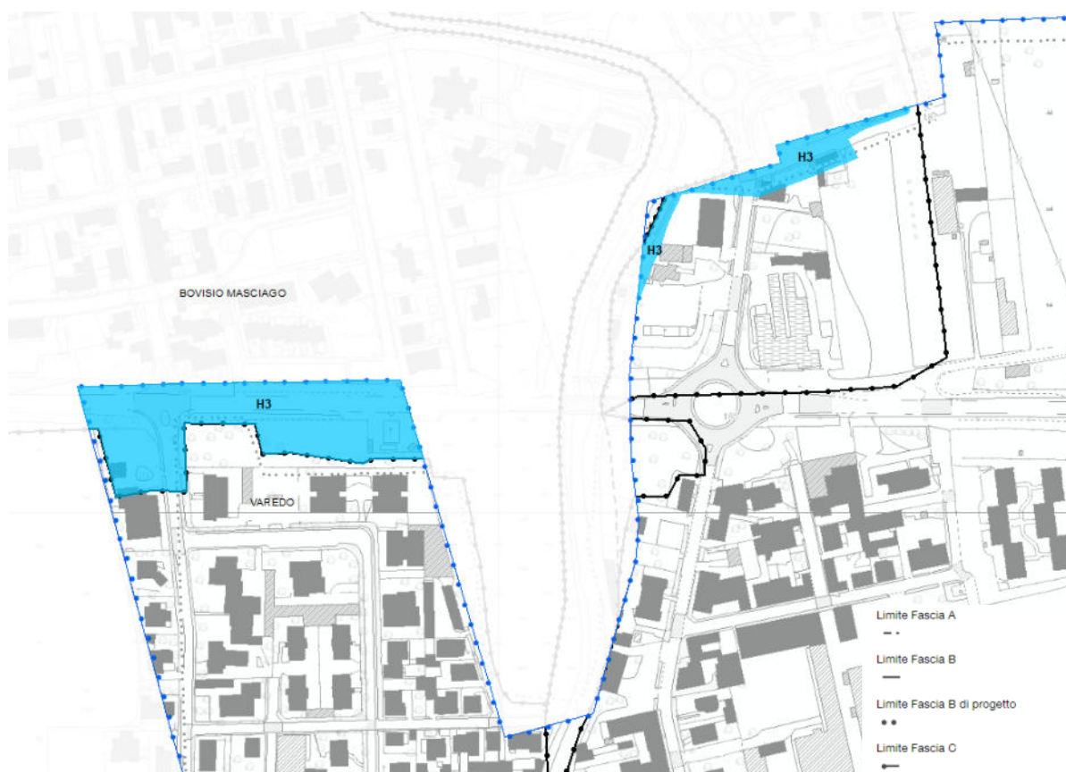
Figura 31. Proposta di zonazione della pericolosità idraulica nelle aree poste a tergo del limite di fascia B di progetto ovvero allagabili per evento con tempo di ritorno pari a 100 anni. Le aree in bianco si trovano ad una quota superiore rispetto al livello al colmo assunto
