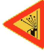
Figura II.390 Art. 31 MATERIALE INSTABILE SULLA STRADA
