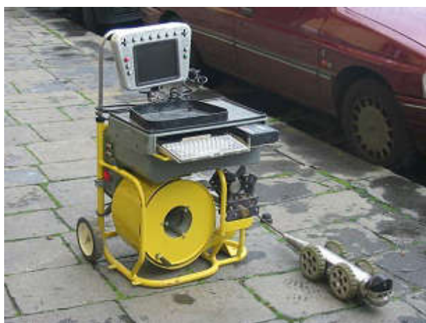
Immagine – Esempio di apparecchiatura per video ispezioni dei condotti fognari
