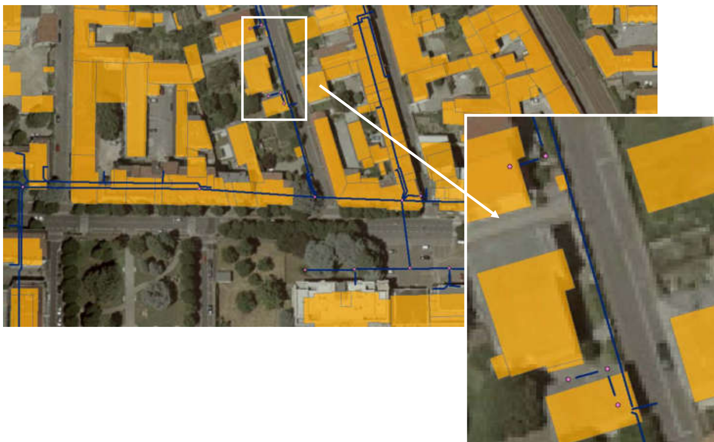
Immagine- File di partenza .shp della rete Telecom con evidenti problemi di georeferenziazione su Dbt e mancata topologia tra archi e nodi.
